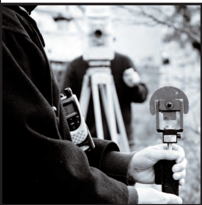
Tachéomètre. Les progrès techniques (télécommandes, GPS) ont diminué le temps de travail sur le terrain.
