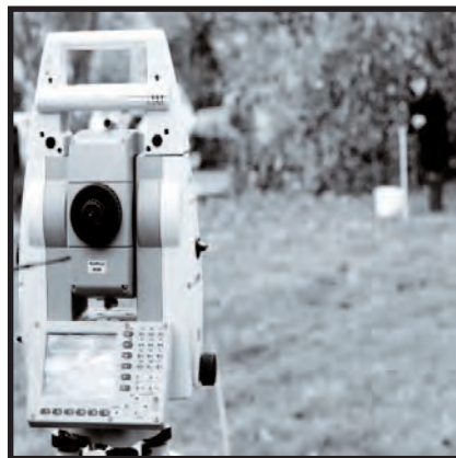
Tachéomètre. Les progrès techniques (télécommandes, GPS) ont diminué le temps de travail sur le terrain.
