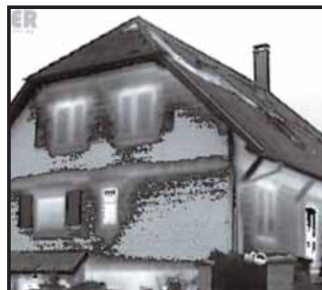
A l'aide d'une caméra spéciale, la thermographie à infrarouges permet d'analyser un bâtiment pour trouver les défauts d'isolation et d'étanchéité. Photos L.Cheviet (à g.) et DER (à dr.).
