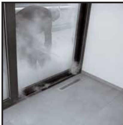
Test d'étanchéité à l'air, à l'aide d'une porte blowerdoor (à g.). En mettant le bâtiment en dépression ou en surpression, on analyse le taux de renouvellement d'air et la perméabilité. Photos DER.
